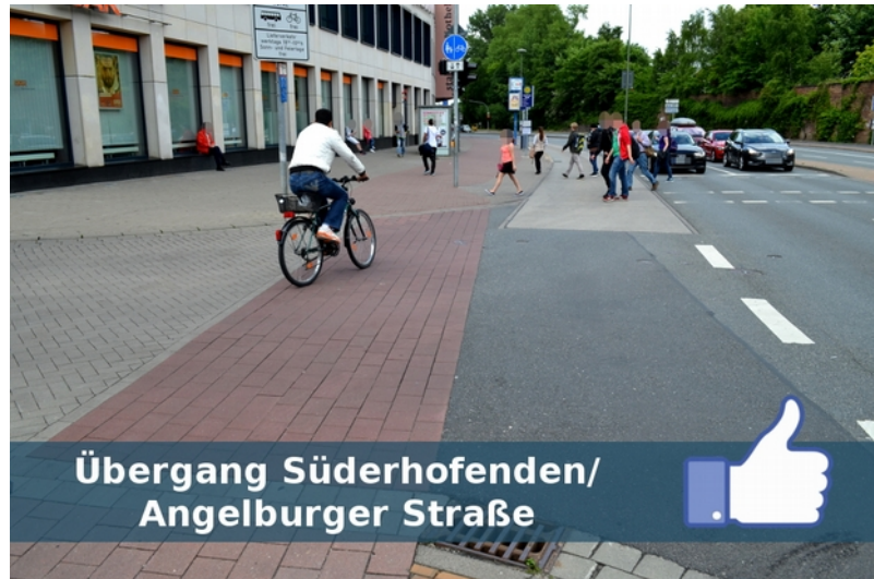
Positivbeispiel für einen barrierefreien Übergang zwischen Straßenteilen
